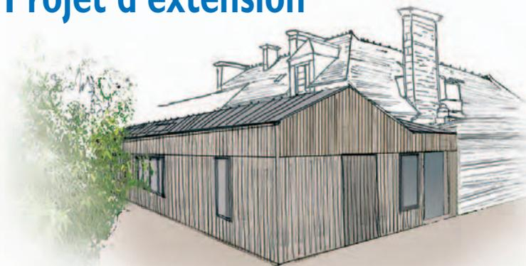
L'Atelier du canal nous présente l'Avant-Projet Sommaire de l'extension de la cantine d'une surface nouvellement créée de 68 m<sup>2</sup> dont 48 m<sup>2</sup> pour le réfectoire. Cette extension est proposée en bardage bois pour rappeler le préau et le centre de loisirs.
